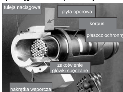
Fot. 4. Budowa zakotwienia czynnego Ex-54 prefabrykowanego kabla zewnętrznego
