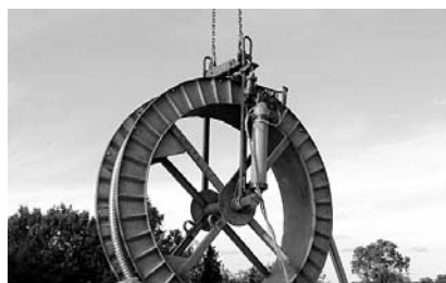
Fot. 2. Urządzenie do rozwijania kabli prafabrykowanych
