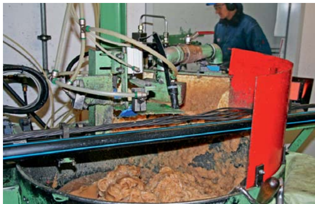
Fot. 3. Automat do zabezpieczenia splotów smarem antykorozyjnym (kotwy stałe i semi-stałe)
