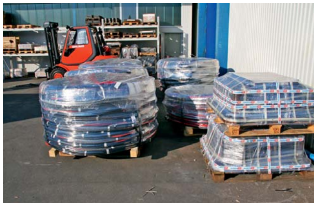
Fot. 2. Prawidłowo przygotowane do transportu kotwy linowe wraz z głowicami kotwiącymi
